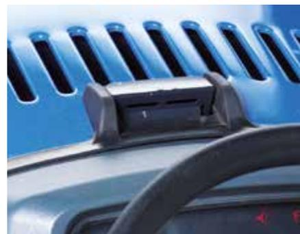
Guter Wartungszugang: ergonomischer Griff zum Öffnen der Motorhaube. Beim Öffnen der Motorhaube wird über einen ISEKI-Sicherheitsschalter der Motor ausgeschaltet.
