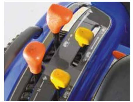
Durchdachte Bedienung: gelb = Zapfwelle, orange = Motor/Fahrertrieb. Äußerst leichtgängiger und präziser Hebelmechanismus.
