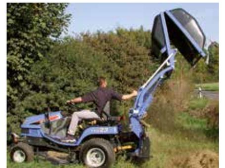
Die Hochentleerung GLS 610 mit einem 600-Liter-Grassammelbehälter ist das ideale Gerät zur Grasaufnahme für Kompakt-Dieseltaktoren der 20 -24 PS Klasse.
