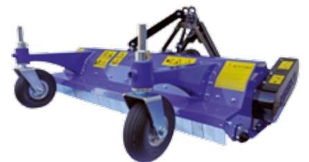
ISEKI-Schlegelmäher werden für den Front- oder Heckanbau angeboten. Besonderer Wert wird auf eine robuste Bauweise gelegt. Nur so können Langgrasmäher dauerhaft Höchstleistung bringen.
