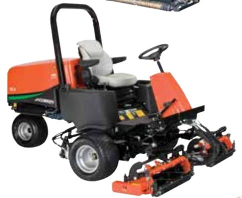
Der TR-3 ist perfekt für Rasenflächen geeignet, auf denen ein anspruchsvoller Pflegestandard gefordert ist. Mit der zuschaltbaren Traktionskontrolle bewältigen Sie auch die härtesten Geländeabschnitte. Der versetzte Anbau der den Konturen folgenden Schneideinheiten ist das Hauptmerkmal dieses Mähers. Der Seitenversatz um 17,5 cm nach links ist ideal für das Schneiden von Bunkeranten. Die ergonomisch gestaltete Bedienerplattform bietet mehr Komfort und verlängert so die potentielle Einsatzzeit.
