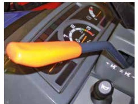
Die Wendeschaltung (Modell AL) ist ideal für schnelle Richtungswechsel im Arbeitseinsatz. Dabei beträgt die Rückwärtsgeschwindigkeit ca. 75% der Vorwärtsgeschwindigkeit. 8 Vor- und Rückwärtsgänge bieten in jeder Fahrsituation den optimalen Geschwindigkeitsbereich. Bei der Hydrostat-Version (AHL) wird diese Funktion durch die 2-Pedalsteuerung ersetzt und erfolgt stufenlos.
