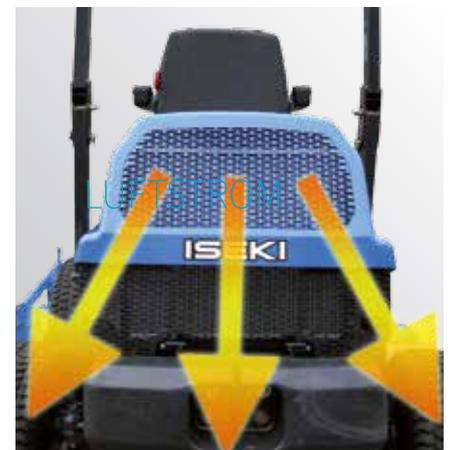
Einmalig in diesem Segment ist die logisch perfekte Umsetzung der Motorkühlung. Die Motorkühlluft wird herausgeblasen und nicht angesaugt. Dadurch verschmutzen Öl- und Wasserkühler bei den SF-Geräten nicht.
