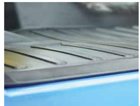
Die durchgehende Gummimatte dämmt den Kabineninnenraum gegen Lärm und Kälte und gewährleistet insbesondere im Wintereinsatz einen kontrollierten Wasserablauf (Reduzierung von Korrosion).
