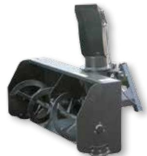
Mit der serienmäßigen Kamindrehvorrichtung können Sie die Wurfrichtung vom Fahrersitz aus hydraulisch steuern. Lieferbar in Arbeitsbreiten von 117 und 140 cm.
