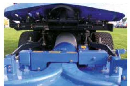
Kurzer Saugweg vom Mähwerk zur Absaugturbine.
