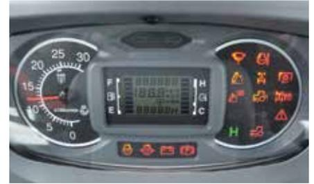
Das neue Display mit Digital- und Analoganzeigen zeigt dem Fahrer alle wesentlichen Informationen wie zum Beispiel Kontrollanzeigen für Allrad-Betrieb, Heckkraftheber, Zapfwelngeschwindigkeit, Fahrgeschwindigkeit und Betriebsstunden-Anzahl.
