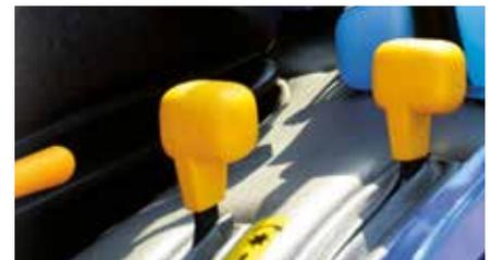
Hochpräzise Vorwahlhebel für Fahrtrieb und Zapfwellen.
