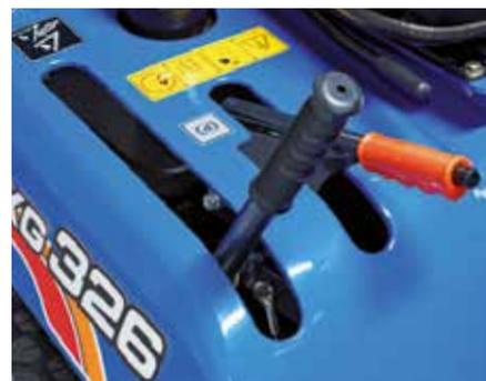
Reinigungsklappe und Handbremshebel
