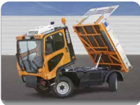
Das Grundmodell des T-1700 ist mit einem 4-Zylinder Motor EURO 6 mit 74 KW (101 PS) ausgestattet. Optional beim T-1700 sind Planetenachsen mit max. 285/70 R19,5 LKW-Bereifung möglich. Mögliche weitere Optionen sind u.a. eine Klimaanlage, zweiter Beifahrersitz, elektronischer Fahrtrieb, verstärkte Kipperpritsche mit Hardox-Boden, einer sehr vorteilhaften Vierradlenkung und vieles mehr.
