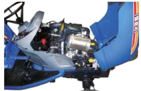
Die Motorhaube ist aus hochwertigem Blech gestaltet. Durch das Vorklappen ist ein schneller Wartungszugang möglich.
