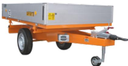
ISEKI-Transporter sind perfekt auf unsere Traktoren abgestimmt. Hydraulische Heckkippvorrichtung, höhenverstellbares Kurbelstützrad für Rangierarbeiten, Auf- und Abbremsung und Rückfahreinrichtung sind serienmäßig im Lieferumfang enthalten.
