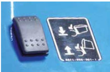
Komfortable Behälterentleerung durch einen Wippschalter im Fahrersitzbereich (nur Modell mit elektrohydraulischer Behälterentleerung).
