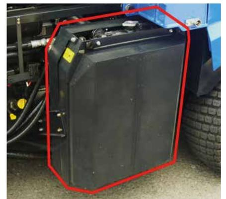
Kühler mit Umkehrlüfter garantiert Temperatur-Stabilität in jeder Situation.
