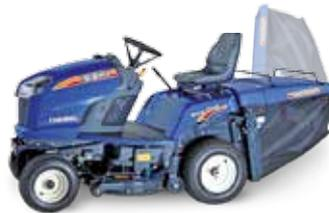
Das hochwertige Fangtuch mit doppellagigen Kantenbereichen sorgt für eine optimale Befüllung bei guter Staubfilterung.
