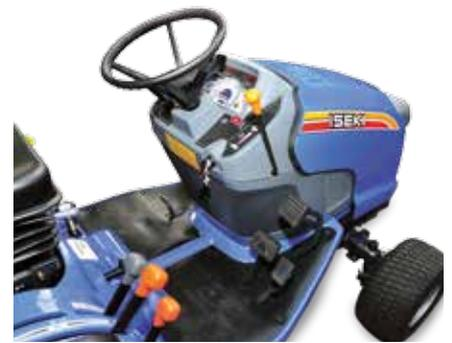
Bequem in der Bedienung. Wechsel von Vor- in Rückwärtsfahrt durch ergonomisch durchdachte 2-Pedal-Steuerung.
