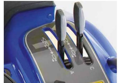
Modell AHL (Bügel) : 2 Hydraulikventile zur Anbaugeräte-Steuerung Modell AL (Bügel): serienmäßig 1 Steuergerät, zweites optional).
