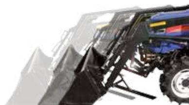
ISEKI-Frontkraftheber müssen für die Verwendung eines Frontladers nicht demontiert werden. Das spart Ihnen viel Zeit und Geld! Die optionale Parallelführung bewährt sich bei vielen Einsätzen.
