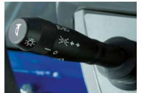
Ergonomisch angebrachter Multifunktionschalter mit Beleuchtungssteuerung.
