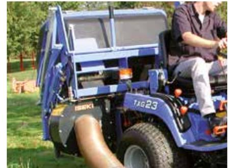
ISEKI-Grasaufnahmegeräte saugen das Gras zuverlässig durch große Stahlturbinen ab.
