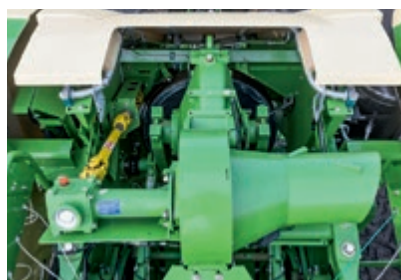
Zusätzlich zur Druckluftreinigung hält ein mechanisch angetriebenes Konstantstromgebläse (Bild oben) die Knoter sauber.
