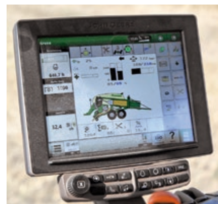
ISO-Bus-fähig: Die Bedienung funktioniert einwandfrei auch per Schlepperterminal. Natürlich bietet Krone aber auch ein entsprechendes Terminal an.
