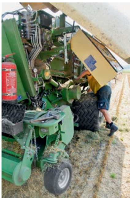
Dank der klappbaren Garnkästen ist die Zugänglichkeit – gerade auch zu den Nadeln – hervorragend!
