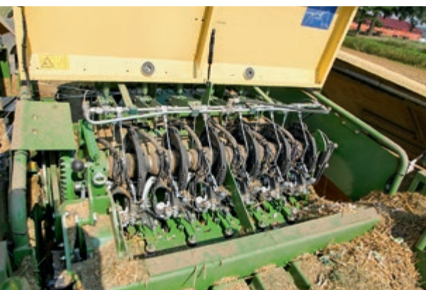
Zusätzlich zur Druckluftreinigung hält ein mechanisch angetriebenes Konstantstromgebläse (Bild oben) die Knoter sauber.
