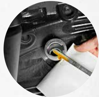
Prüfen des Ölstands und Nachfüllen ohne Anheben der Motorhaube.
